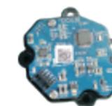
采用24位多圈光电绝对值编码器,可以实现不少于1024转的位置记录,最小分辨率小于0.1%(EMT的最小分辨率为5°),绝对值式设计可以保证设备在失电条件下对于阀门位置的准确记录。
