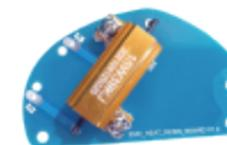
电动执行器内部安装防潮加热电阻,用来去除内部凝露防止电器部件受到侵害。
