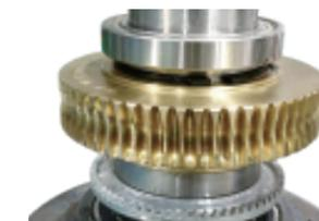
采用高强度合金钢的蜗杆及高耐磨性的铜合金蜗轮,针对于其特性开发出蜗轮蜗杆啮合仪,对每一对蜗轮蜗杆安装前进行检测,确保安装后能最大效率的传递力矩。
