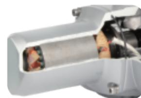
F级绝缘电机,电机绕组的的不同位置布有2颗温控开关来监测电机的温度,冗余的设计保障了电机的运转安全(可选配H级)。
