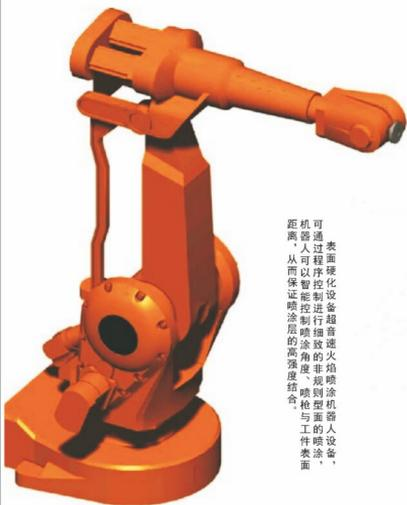
可通表面硬化设备超音速火焰喷涂机器人，可远程控制进给角度、喷嘴到涂层的距离，从而保证涂层的高精度结合。
