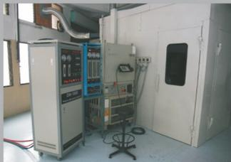
公司优化选择的超音速喷涂低温超导及机器人、喷枪控制设备，可表面硬化口径达DN500球阀芯。
