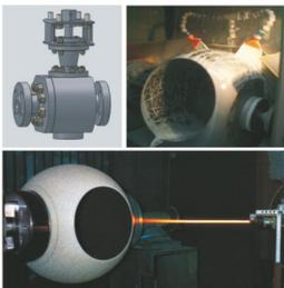
1、球体采用不锈钢锻件制造，球体表面喷焊镍基合金，硬度达到HRC60~62，在球体内通道和唇口处可根据用户要求堆焊硬质合金材料，完全满足耐磨要求。
