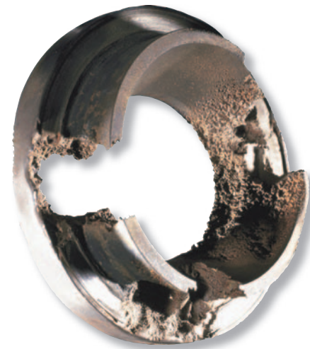
Kavitationsbedingte Schäden am Sitzring führen zu Leckagen, die nachgeschaltete Komponenten beschädigen können.
