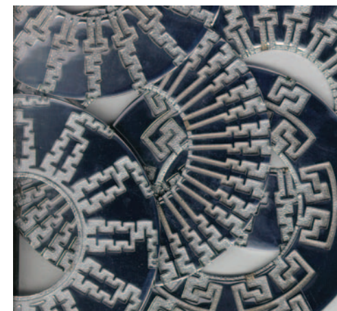
Die zahlreiche unterschiedliche Strömungswege und Stufen umfassenden Regelementkonzepte des Ventils von CCI sollen unter allen Strömungsbedingungen über den gesamten Ventilhub hinweg eine optimale Ventilleistung gewährleisten.
