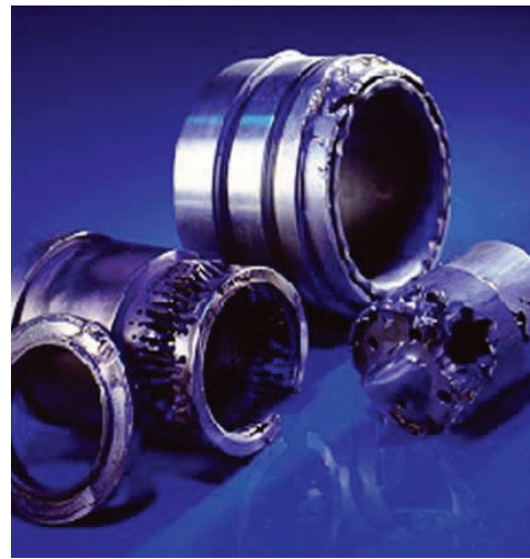
Der Beweis: Offensichtliche Erosionsschäden aufgrund hoher Strömungsgeschwindigkeit bei einem Einstufenregelement und an Regelementen von Ventilen.
