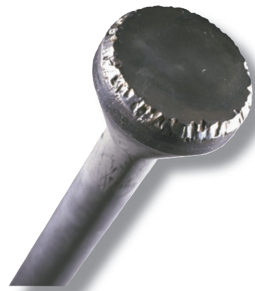
Erosionsbedingte Schäden an einem Ventilkegel eines anderen Herstellers, die durch hohe Strömungsgeschwindigkeiten verursacht wurden, führen zu schlechtem Absperrverhalten.
