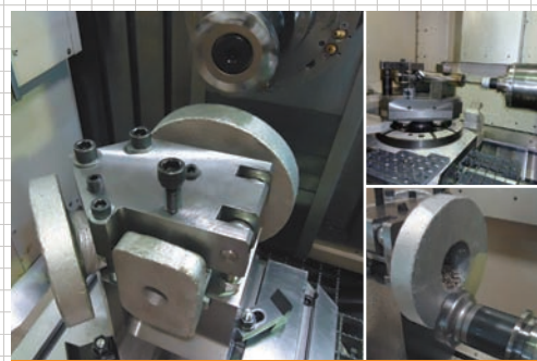
平接釜底阀专用大型数控铣床（加工中心）
