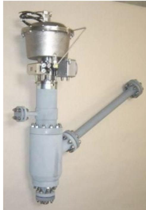
**出口保护管**- 用户可以选择在阀出口增加一段保护管，管内有一个内硬质管，防止出口高速煤粉损坏配管。
